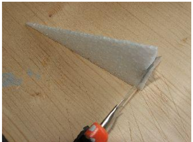
Šíkmo seříznout a zabrousit zadní díl přechodu..
