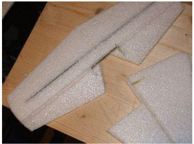
Před přilepením motorové přepážky vyříznout drážku pro kabely motoru.
