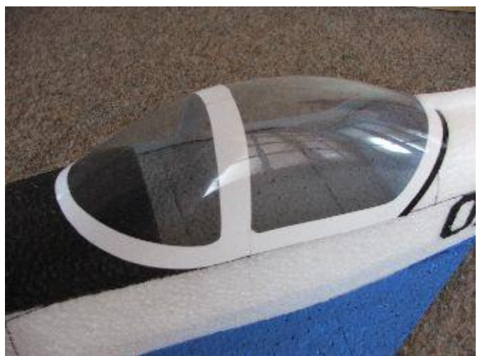
Ostříhnout kabinu a nalepit orámování
