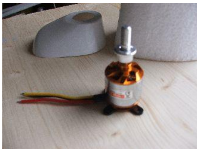
Sestavíme motor s upevňovacím křížem.
