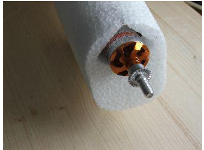
Motor přišroubujeme na překližkovou přepážku.
