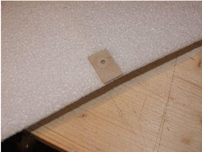
Přilepit překližkovou podložku pro šroub.
