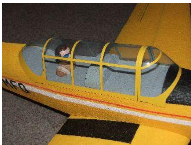
Ostříhnout kabinu a nalepit orámování
