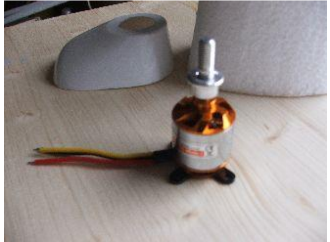
Sestavíme motor s upevňovacím křížem.
