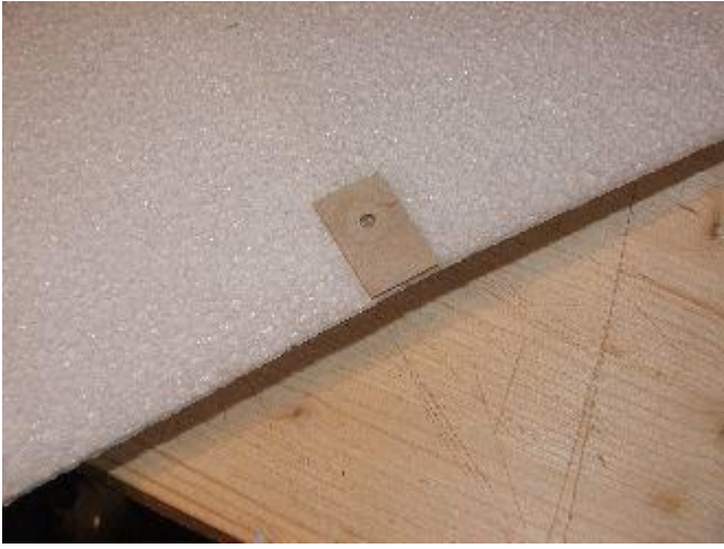
Přilepit překližkovou podložku pro šroub.
