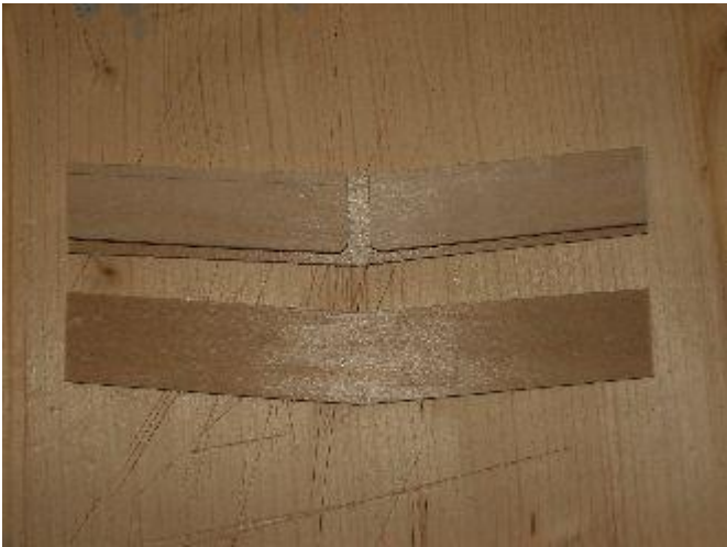
Slepit překližkové lože podvozku.
