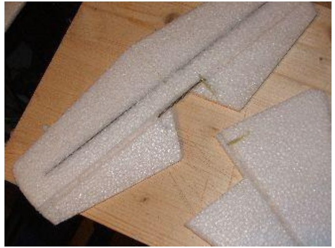
Vyříznout drážku a zalepit uhlíkovou výztuhu a spojku výškovky.
