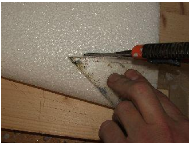
Vyříznout drážku pro podvozek.
