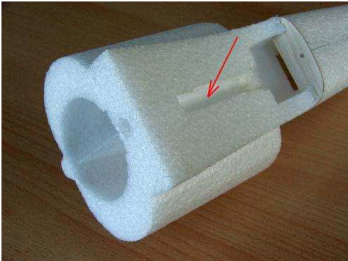
Ve spodní části vyřízneme drážku pro kablíky.
