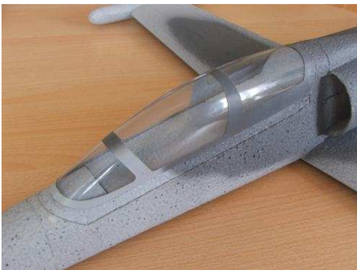
Po nabarvení modelu přilepíme rám kabiny z papíru.
